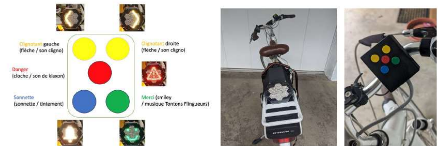
Figure 1 : schéma et photos du boîtier de commande avec ses fonctionnalités 1
